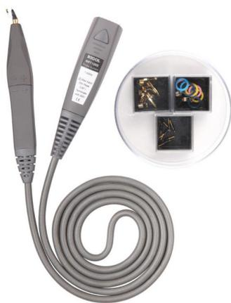
**Активный несимметричный высокочастотный низковольтный пробник RIGOL RP7150S** представляет собой высокочастотный кабель со встроенным блоком СВЧ усилителя, подключаемым сменным наконечником с одной стороны и разъемом для соединения со входом осциллографа, с другой стороны.
