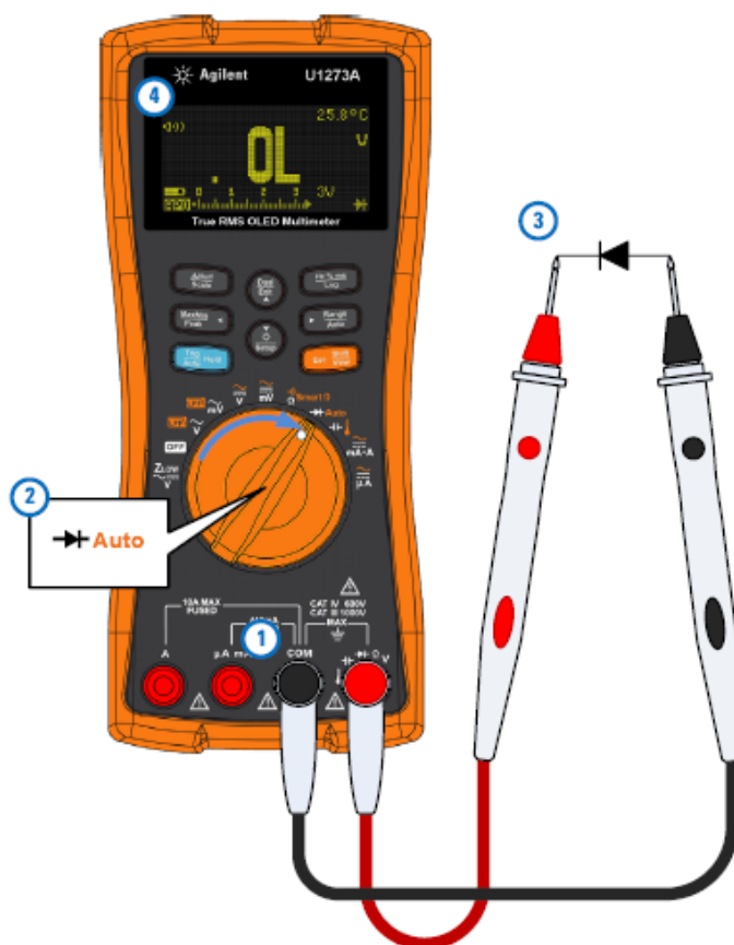
Рис. 2-21 Проверка диода при обратном смещении
