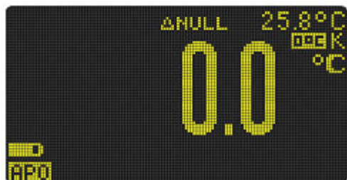
Рис. 2-28 Измерение температуры без компенсации температуры окружающей среды
