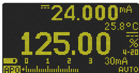
Рис. 2-33 Индикация процентного значения тока 4 ÷ 20 мА
