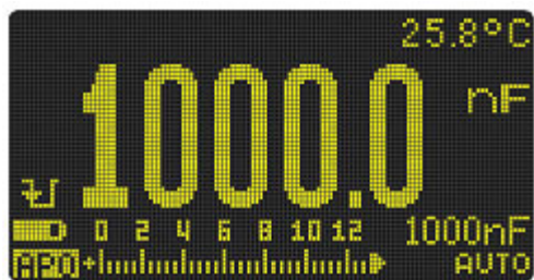
Рис. 2-24 Индикация результата измерения емкости
