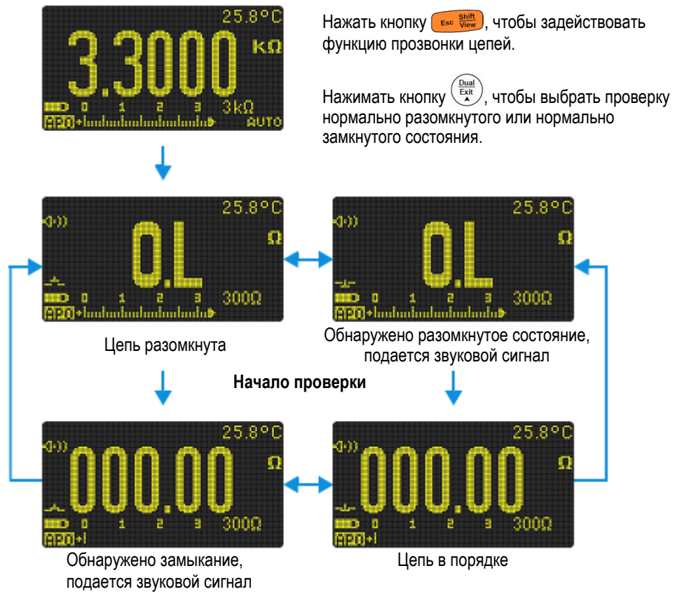
Рис. 2-13 Операции при прозвонке цепи
