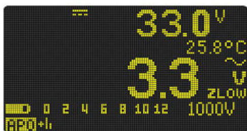
Рис. 2-10 Индикация в режиме Z_{LOW}
