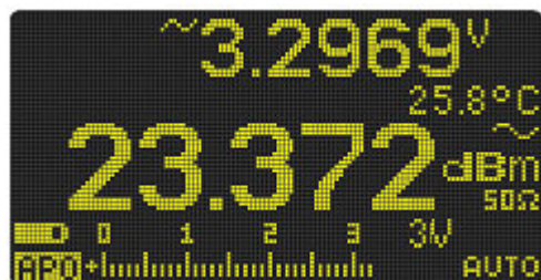
Рис. 2-8 Индикация в децибелах от милливатта (dBm)
