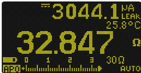
Рис. 2-16 Индикация результата измерения сопротивления в режиме Smart \Omega (с индикацией тока утечки)
