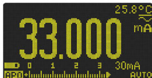
Рис. 2-7 Индикация постоянного и переменного тока (AC+DC)
