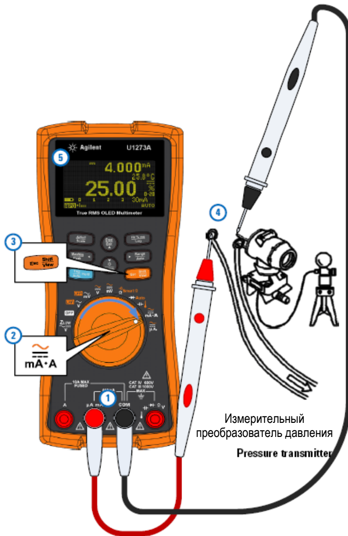
Рис. 2-34 Измерение процентного значения тока в диапазоне 0 ÷ 20 мА
