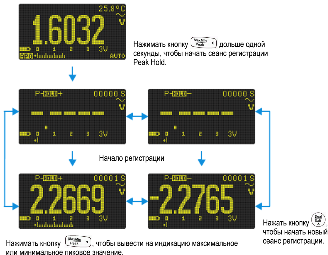
Рис. 3-6 Операции в режиме регистрации пиковых значений
