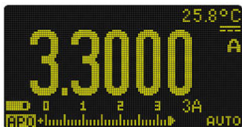
Рис. 2-29 Индикация постоянного тока
