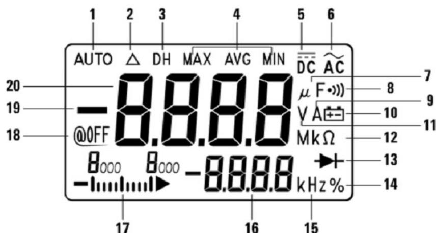
Рис. 1-3 Жидкокристаллический дисплей со всеми элементами индикации
