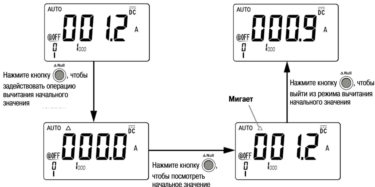
Рис. 3-5 Индикация в режиме вычитания начального значения
