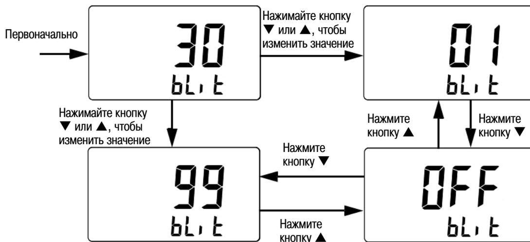
Рис. 4-5 Установка задержки выключения подсветки дисплея
