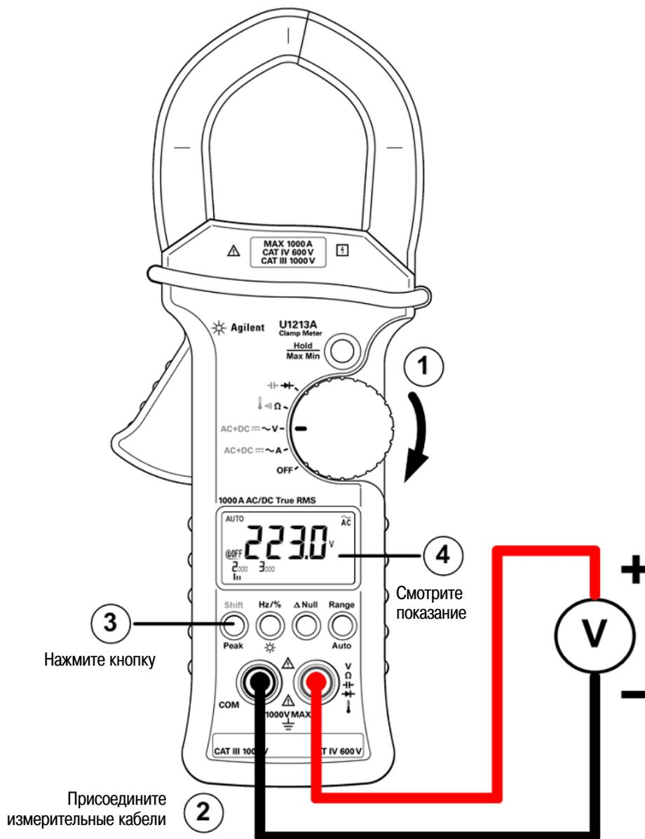
Рис. 2-2 Измерение напряжения
