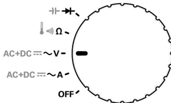
Рис. 1-6 Поворотный переключатель мультиметра
