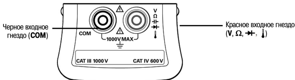
Рис. 1-7 Входные гнезда мультиметра
