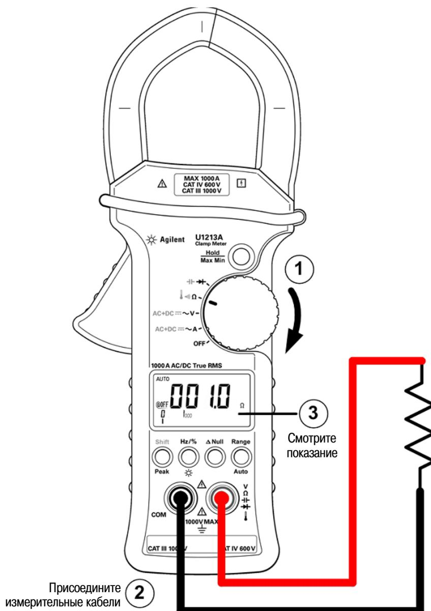
Рис. 2-3 Измерение сопротивления
