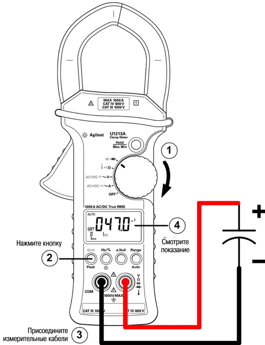
Рис. 2-7 Измерение емкости
