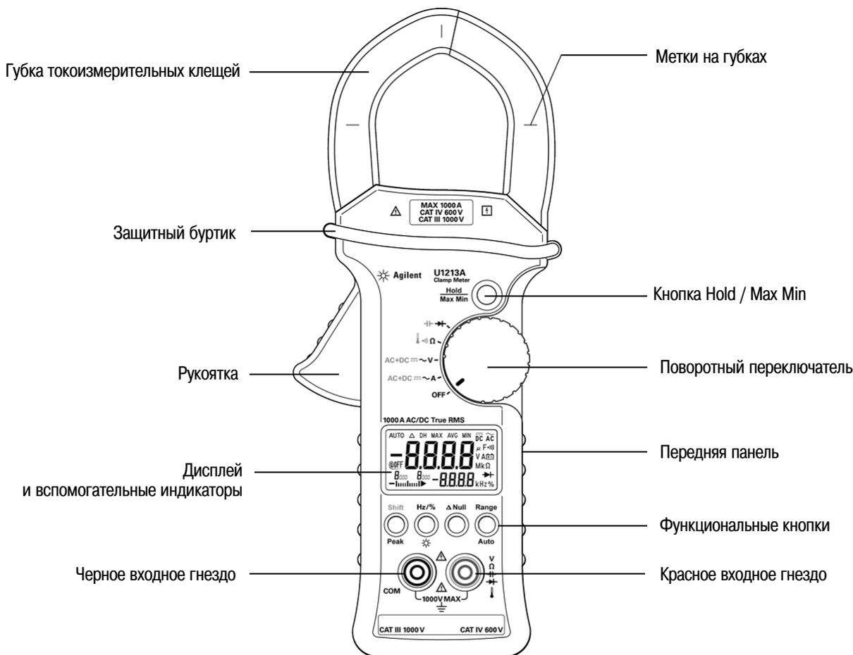
Рис. 1-2 Передняя панель мультиметра клещевого типа
