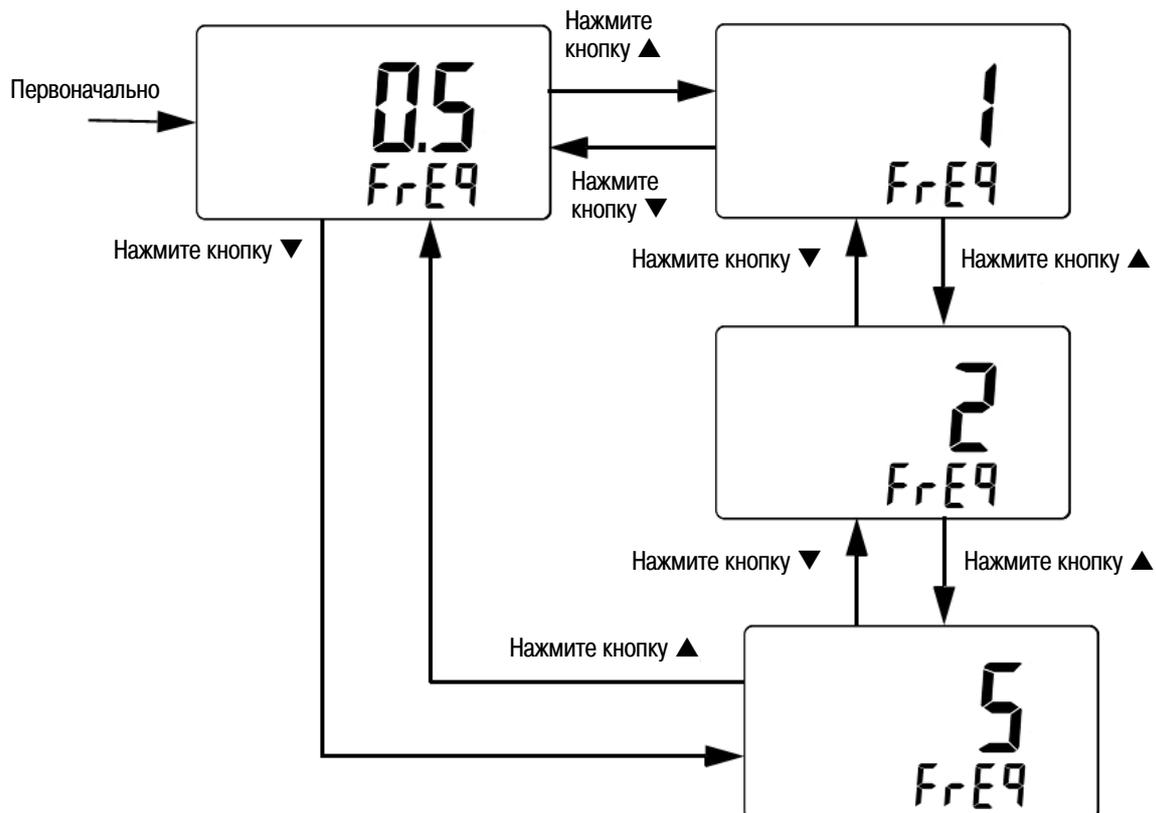
Рис. 4-1 Установка минимальной частоты
