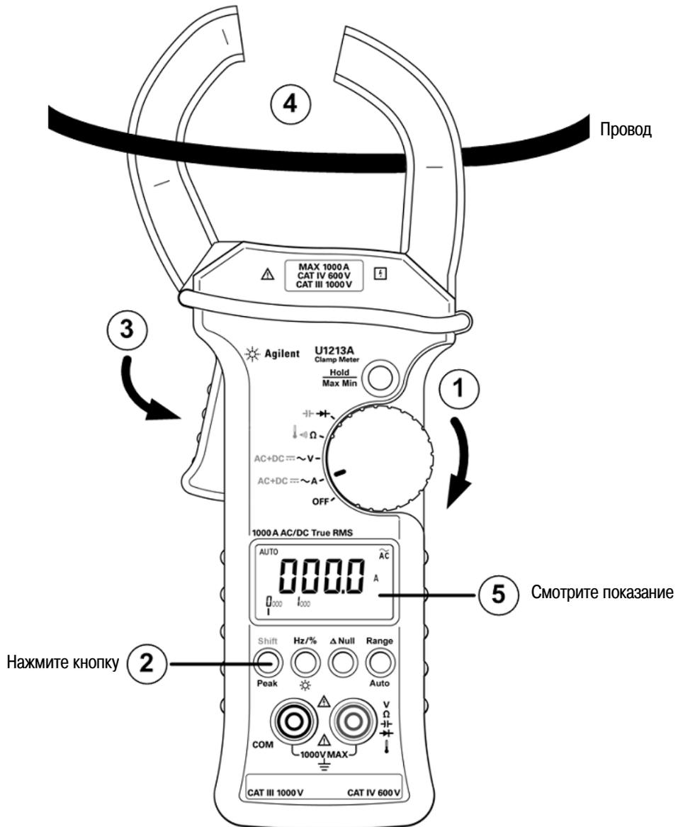
Рис. 2-1 Измерение тока
