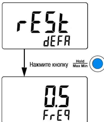
Рис. 4-7 Восстановление заводской установки параметров
