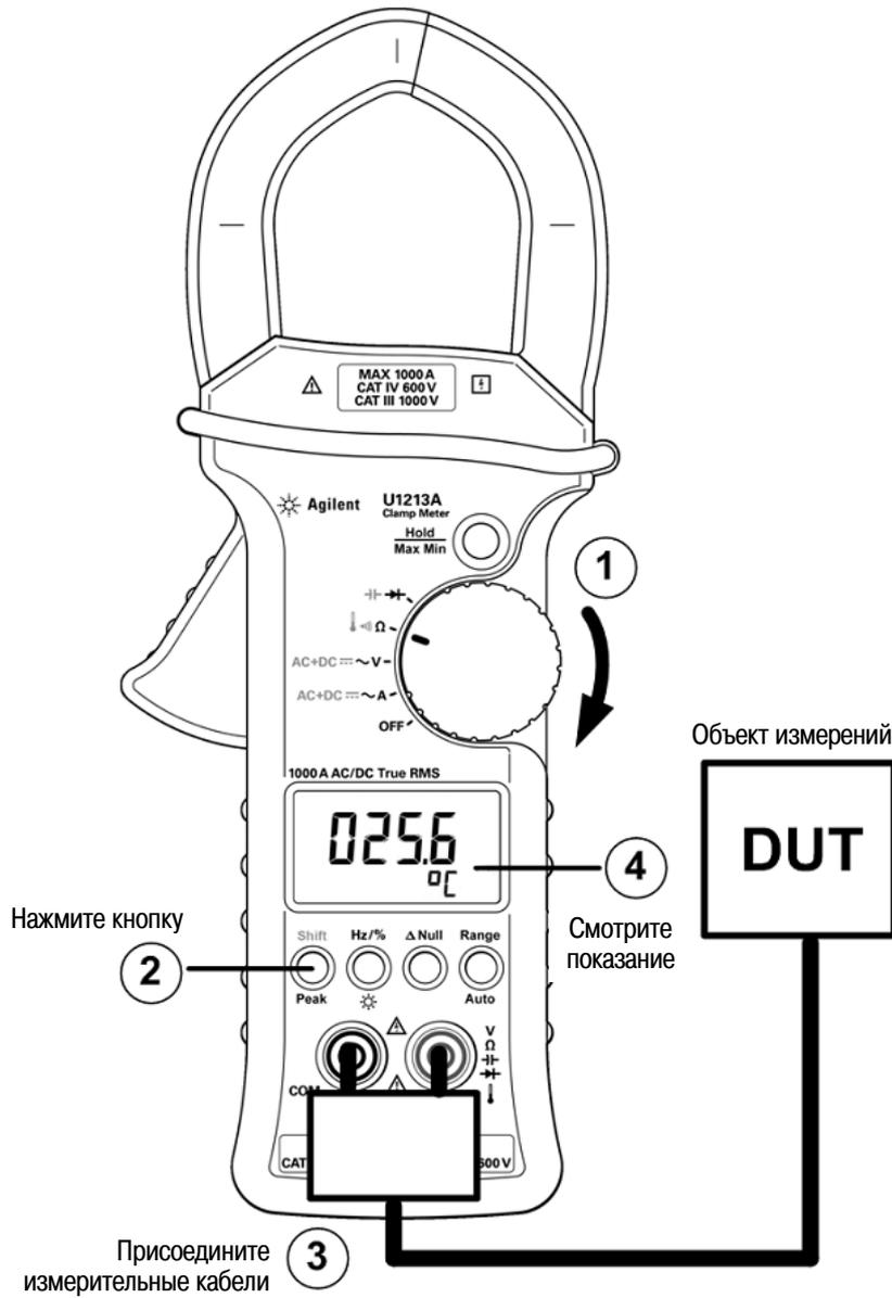
Рис. 2-8 Измерение температуры
