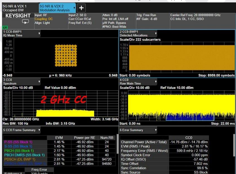
РИСУНОК 4. 5G NR анализ модуляции нисходящей линии с компонентной несущей 2000 МГц
