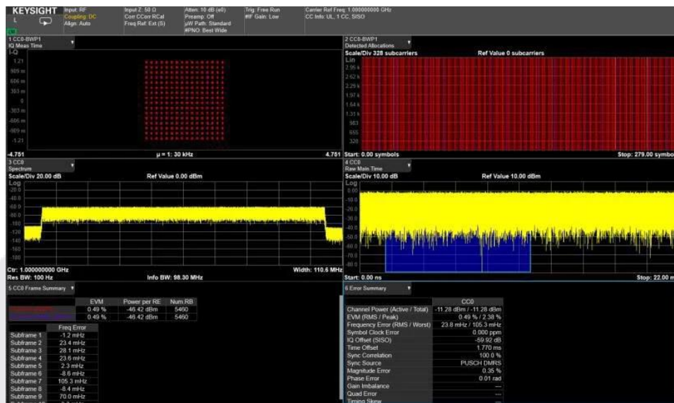
РИСУНОК 7. Измерение 5G NR анализ модуляции восходящей линии
