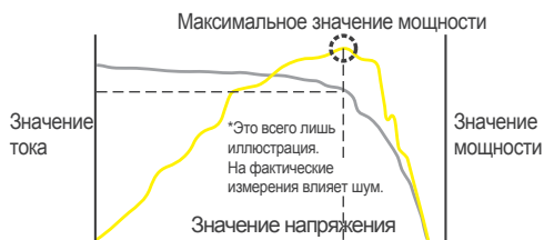
Типичные измерения напряжения, тока и мощности в системе управления MPPT
