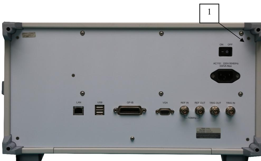
1 – место пломбировки от несанкционированного доступа.
