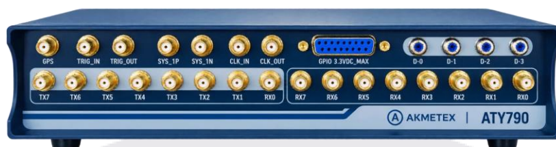
АТУ790. Многоканальная SDR-платформа для исследований 6G. Вид спереди
