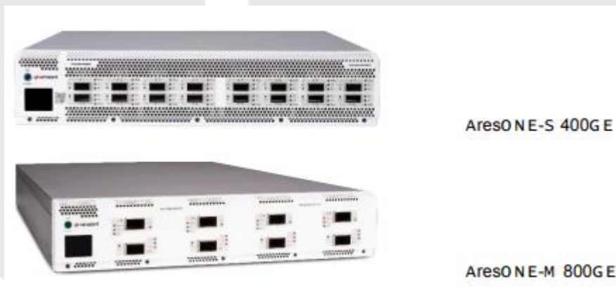
Рисунок 3. Варианты испытательных движков KAI — аппаратные устройства AresONE и программные конечные точки
