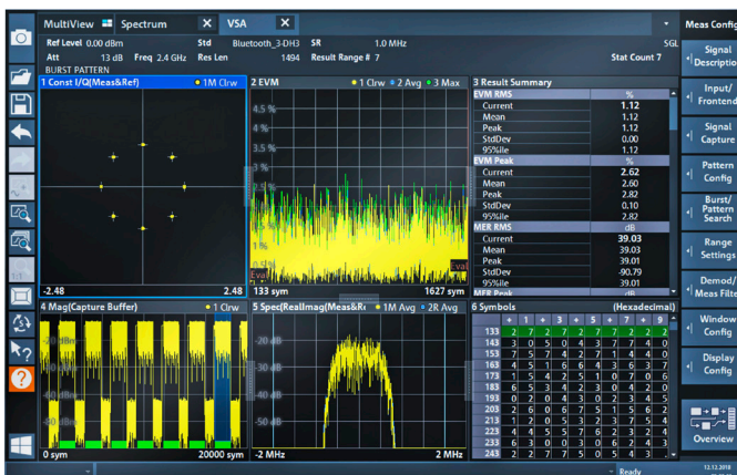
Демодуляция сигнала Bluetooth® с помощью опции R&S®FPL1-K70
