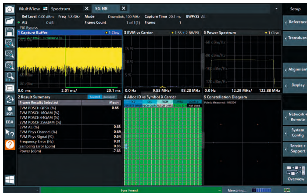
Анализ сигнала 5G NR с опцией R&S®FSVA3-K144 (нисходящий канал) и R&S®FSVA3-K145 (восходящий канал)
