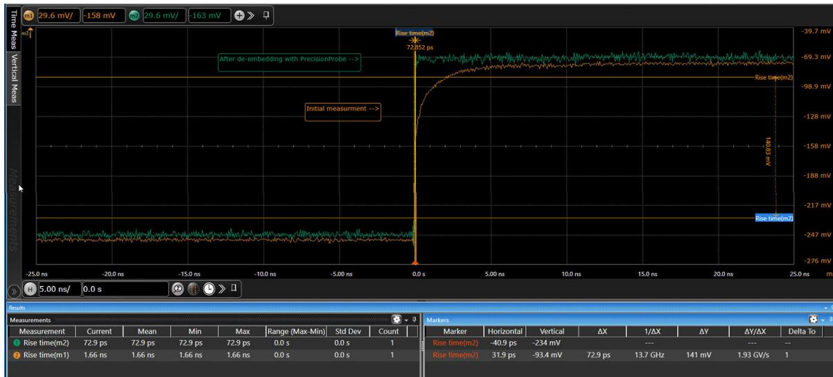
Данный пакет включает в себя два программных инструмента, PrecisionProbe и InfiniiSim Basic, предназначенных для устранения влияния соединительных кабелей и оснастки на результаты измерений. PrecisionProbe позволяет определять характеристики пробника, кабеля или оснастки; InfiniiSim позволяет моделировать их на основе результатов измерений.
