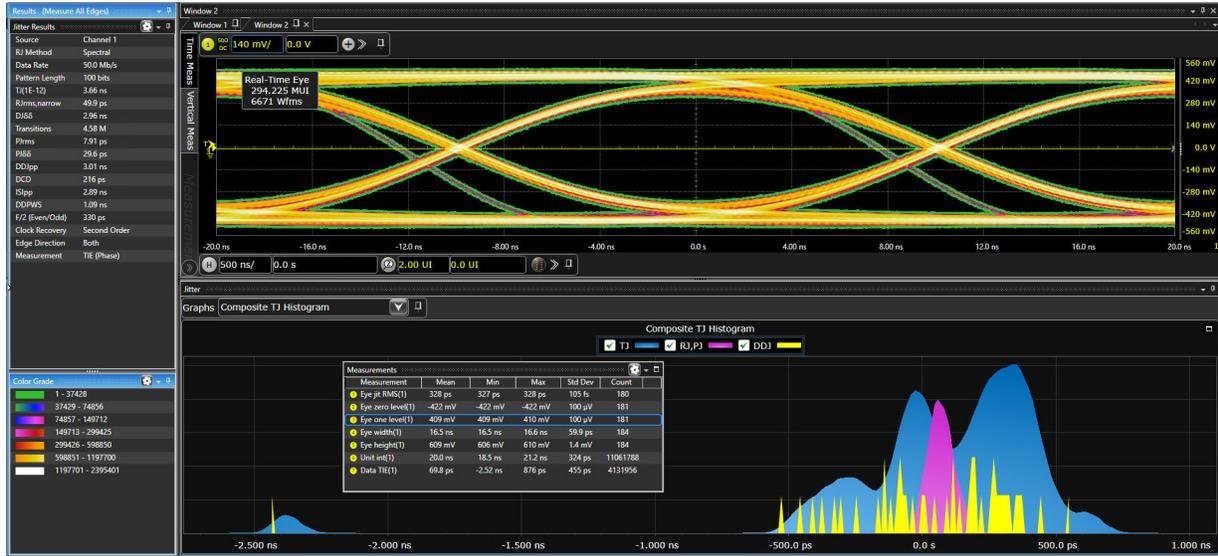
Этот пакет предлагает расширенный статистический анализ сигналов высокоскоростных цифровых интерфейсов по вертикальной (напряжение) и горизонтальной (время) осям, а также анализ фазового шума. В результате получается наиболее полное программное решение для анализа джиттера и шума на осциллографе реального времени.
