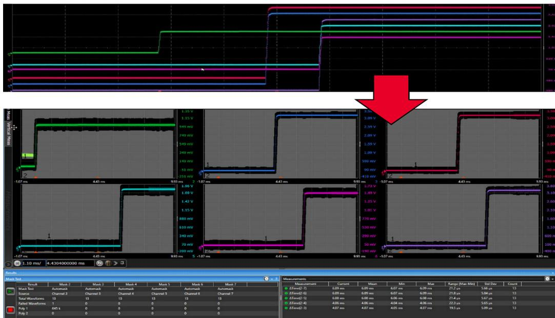
Благодаря разделению сигналов по различным шкалам и возможности независимого тестирования по маске на каждом канале можно непрерывно тестировать эти шесть шин питания в течение тысяч циклов запуска. Обратите внимание, как результаты измерений и тестирования по маске отображаются на на одном экране отчета о тестировании.
