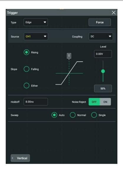
Figure 8.3 Edge Trigger Setting Menu
