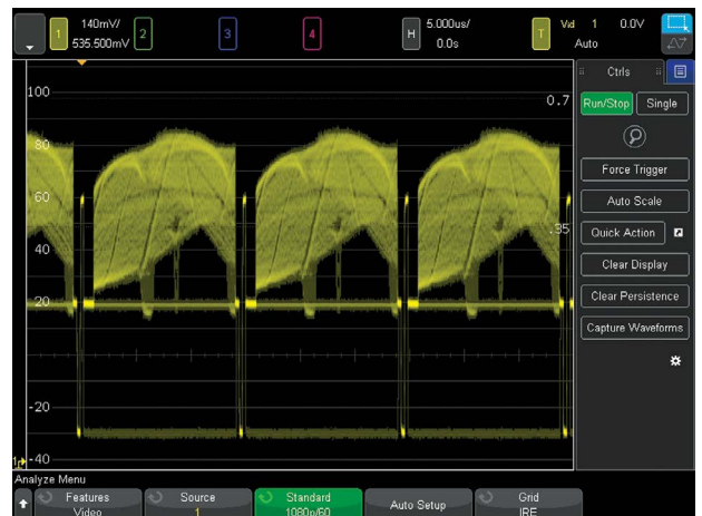
Рис. 27. Синхронизация по сигналу HDTV формата 1080p.
