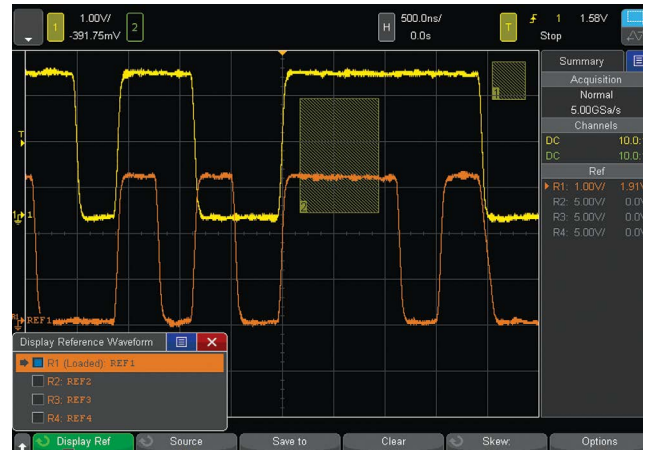
Рис. 34. Возможность сохранения и загрузки до четырех опорных сигналов.
