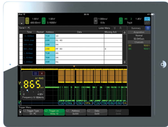
Рис. 38. Виртуальная передняя панель на планшете.
