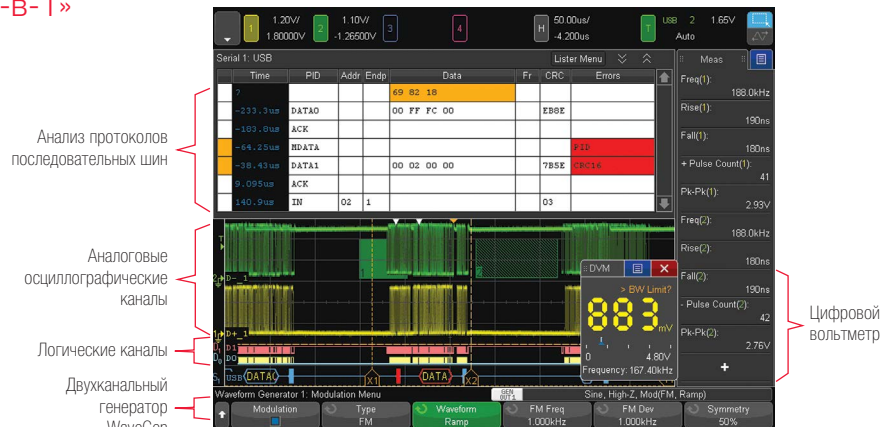
Рис. 17. Осциллографы серии 4000 X обеспечивают возможность органичной интеграции семи приборов в одном.
