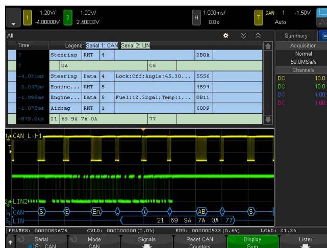
Рис. 20. Одновременное декодирование сигналов шины CAN и LIN и их отображение в режиме «Lister».
