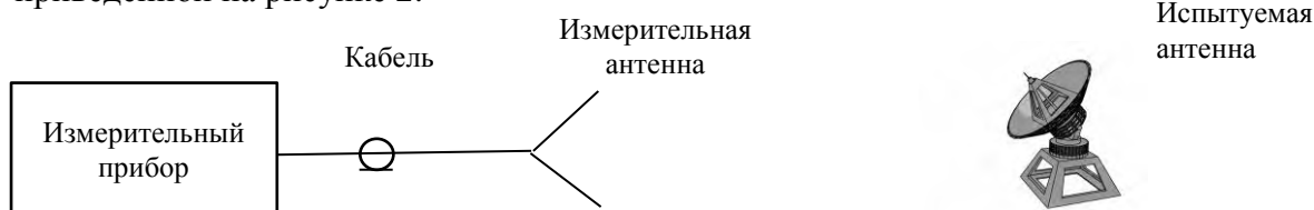
Рисунок 2 – Схема соединения приборов при измерении плотности потока энергии
