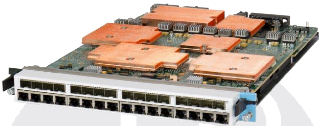
NOVUS-NP 10/1GE16DP — 16-портовый трёхскоростной нагрузочный модуль Dual-PHY
