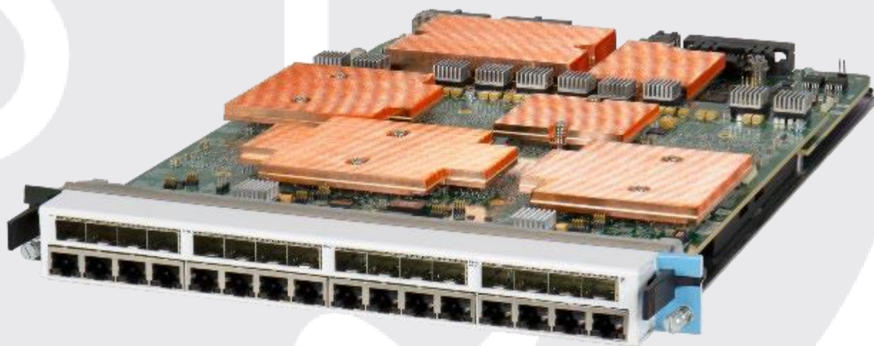
NOVUS10/1GE16DP — 16-портовый трёхскоростной нагрузочный модуль DUAL-PHY
