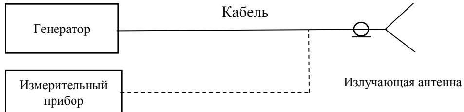
Рисунок 3 – Схема соединения приборов для создания электромагнитного поля с заданной плотностью потока энергии.
