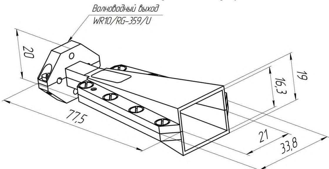
Рисунок 1 – Общий вид антенны П6-135
