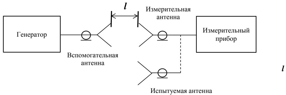
Рисунок 4 – Схема соединения приборов при измерении эффективной площади.
