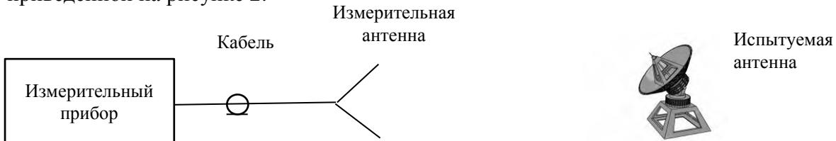
Рисунок 2 – Схема соединения приборов при измерении плотности потока энергии
