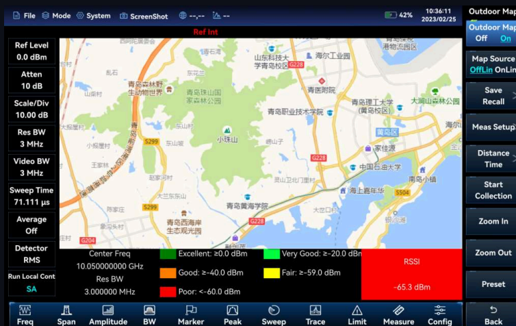
Пример отображения результатов измерения RSSI на карте местности
