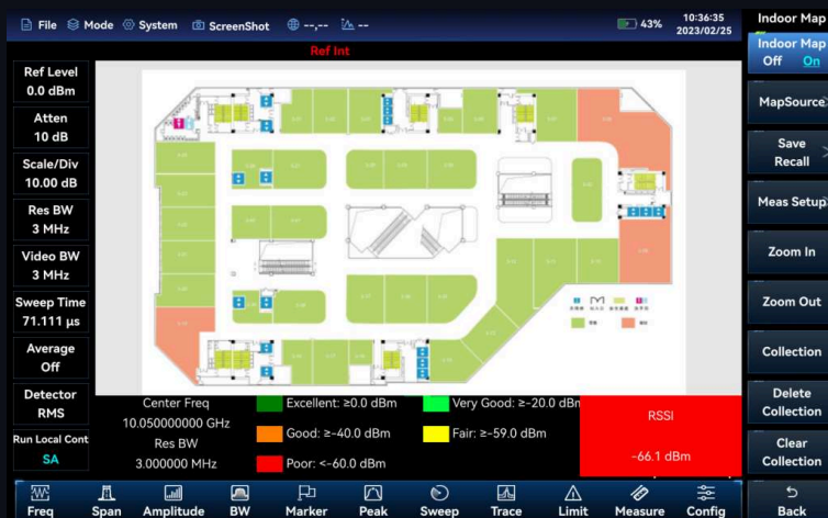
Пример отображения результатов измерения RSSI на плане помещения
