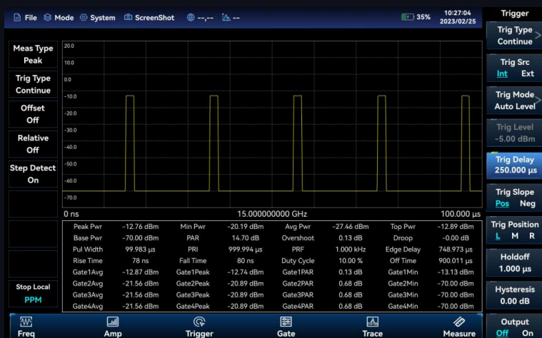
Пример отображения огибающей импульсного сигнала и результатов измерения мощности
