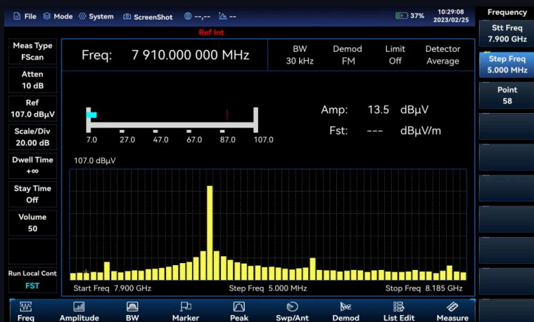
Пример измерения напряжённости поля в режиме сканирования по частоте
