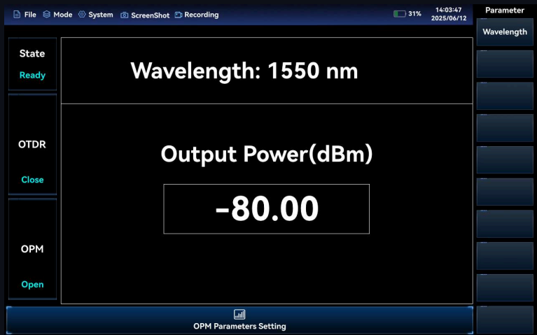
Пример измерения оптической мощности
