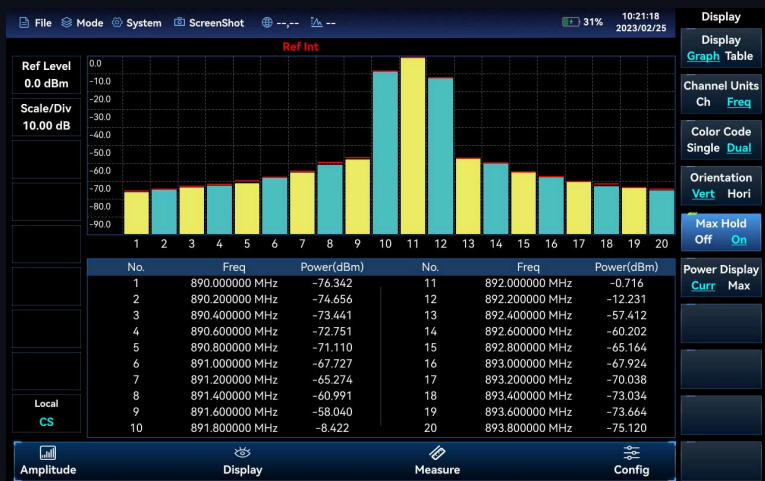
Пример измерения мощности сигналов в 20 каналах
