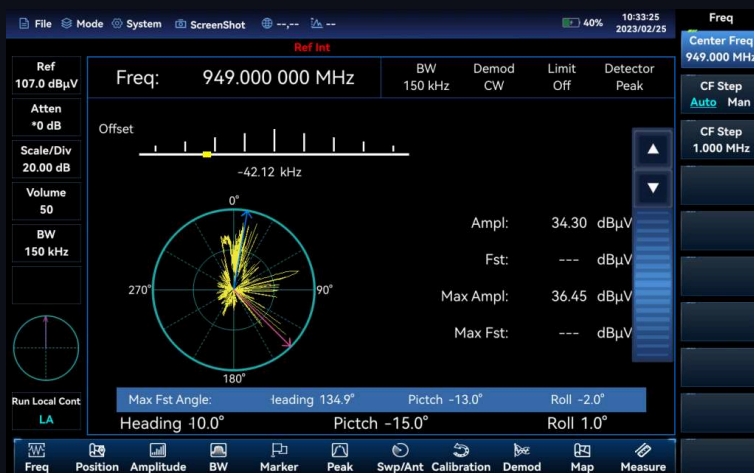
Пример определения направления на источник сигнала
