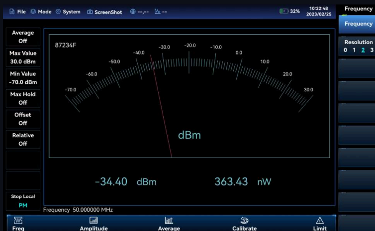
Пример отображения результатов измерения мощности с внешним USB-преобразователем
