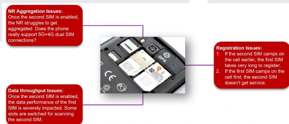
Рисунок 25. Тестирование Dual SIM с использованием Functional KPI
