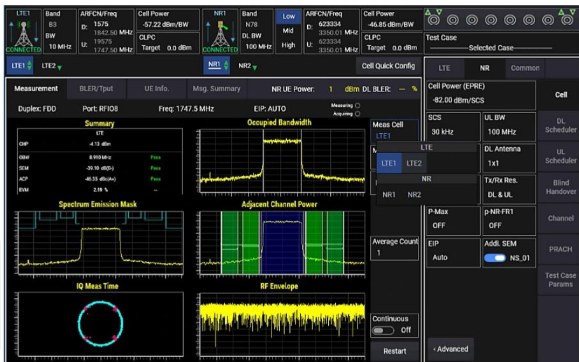
Рисунок 1. Результаты RF-измерений в 5G RF Application Framework компании Keysight
