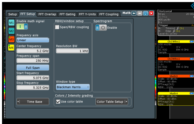
Простая настройка частотного анализа с помощью типовых параметров
