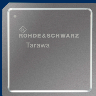
Многочиповый модуль входного каскада осциллографа R&S®RTP
