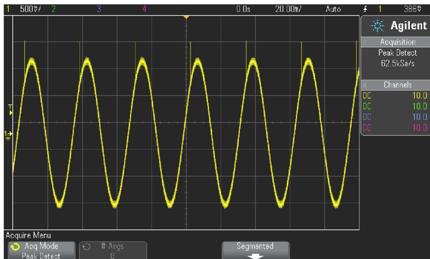
Рис. 25 Синусоидальный сигнал с пиками, режим пикового детектирования
