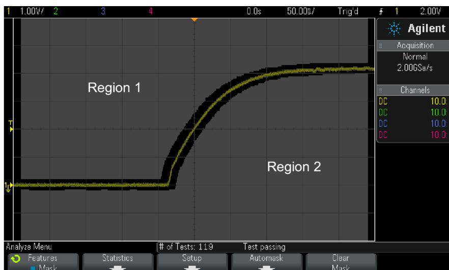
Файл Automask содержит две особых области: область, "прикрепленную" к верхней части экрана, и область, "прикрепленную" к нижней части экрана. Верхняя область обозначается значениями Y "MAX" у первой и последней точки. Нижняя область обозначается значениями Y "MIN" у первой и последней точки.
