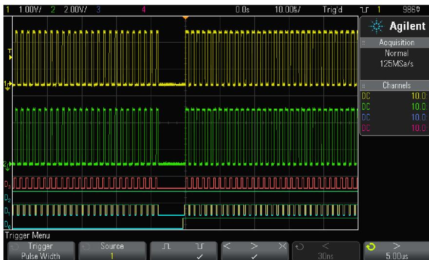
3. Нажмите функциональную клавишу **Source**, затем вращайте ручку Entry, чтобы выбрать канал в качестве источника запуска. Выбранный вами канал индицируется в правом верхнем углу экрана рядом с символом полярности.
