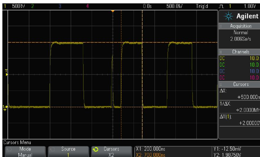
**Рис. 31** Измерение длительности импульса с помощью курсоров
