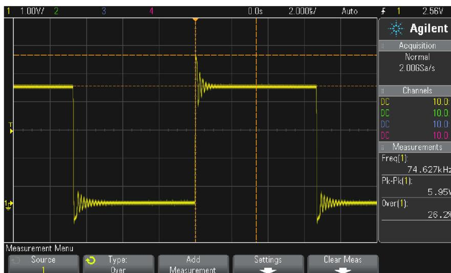
Рис. 34 Автоматическое измерение выброса на фронте импульса
