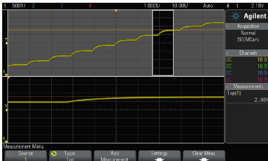
Рис. 33 Область выделения для измерения вершины
