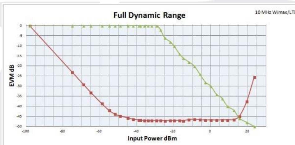
Рисунок 2. Пример измеренного полного динамического диапазона для канала LTE 10 МГц
