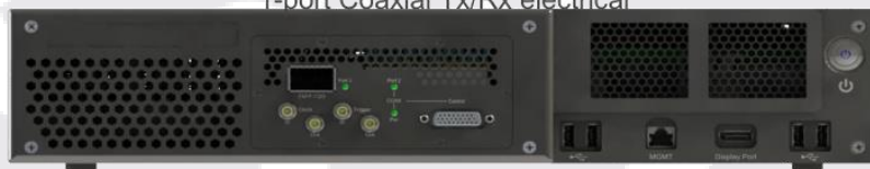
Рисунок 1. Системы G800GE-02 для тестирования FEC и уровней L1–L2
