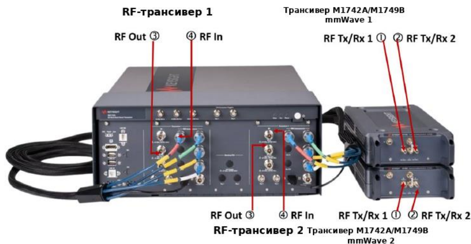
Рисунок 3. S9110A-TR2/TN2 (с опциями F32, F43 или F49), конфигурация 5G Multi-Band Vector Transceiver 1 .
