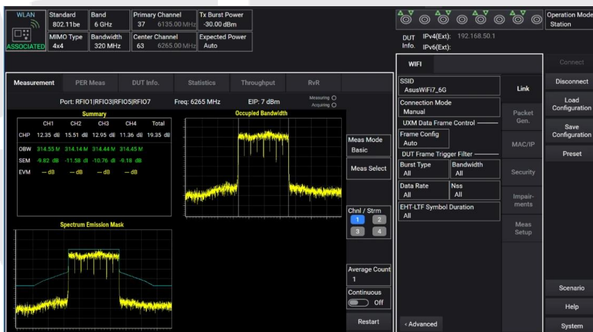
Рисунок 20. Пример тестирования 802.11be с полосой 320 МГц и MIMO 4x4
