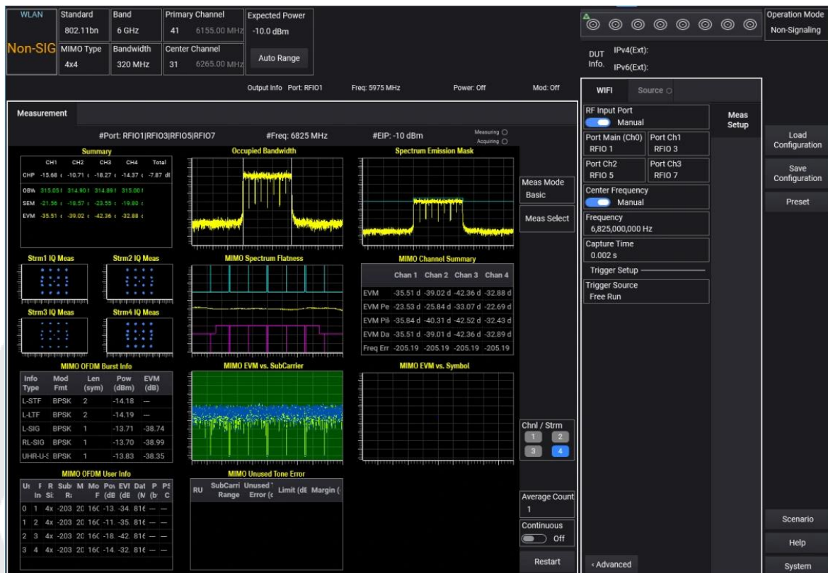
Рисунок 21. Пример тестирования WLAN 802.11bn в Non-Signaling mode
