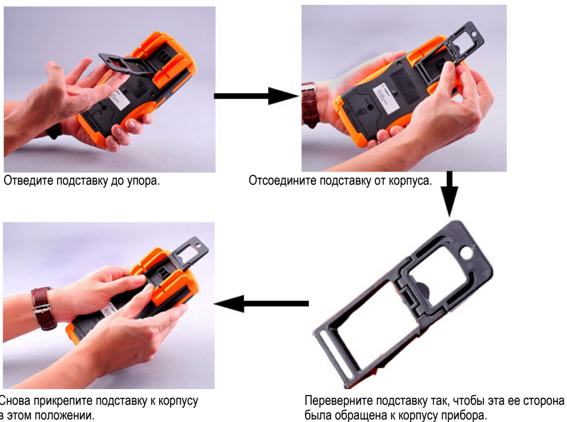
Рис. 1-3 Установка подставки в положение для навешивания мультиметра
