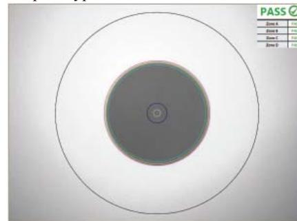
**Определяемые пользователем критерии приемки PASS/FAIL**
