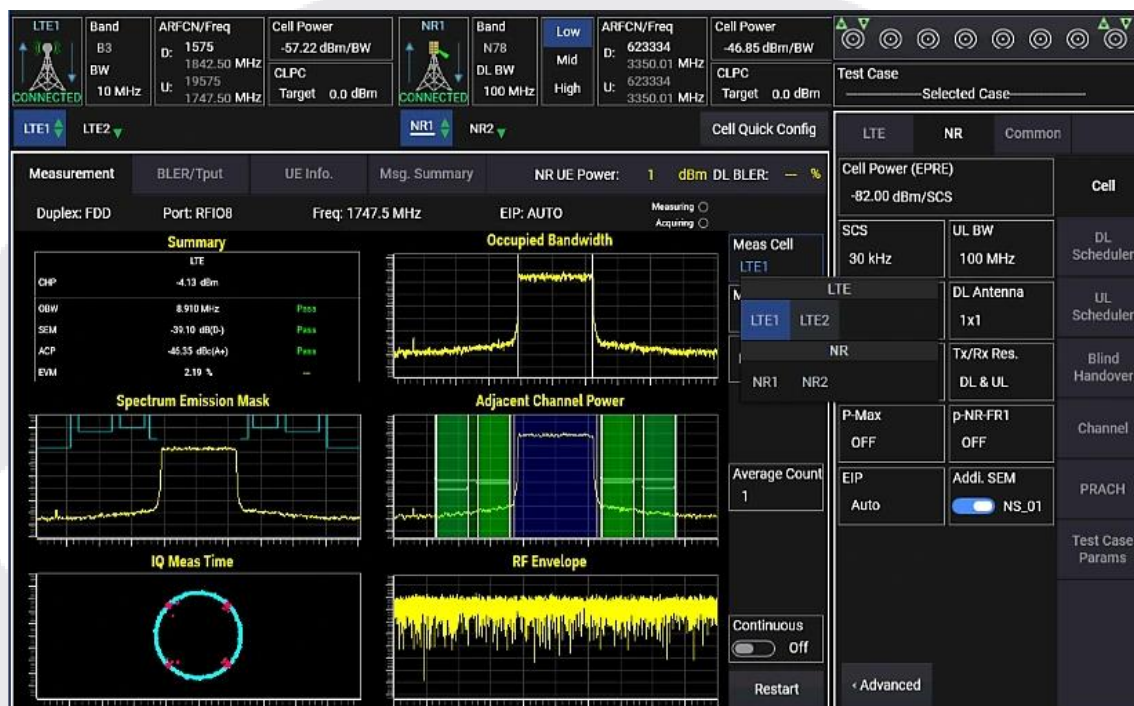
Рисунок 1. Снимок экрана, иллюстрирующий набор измерений в 5G RF Application Framework компании Keysight
