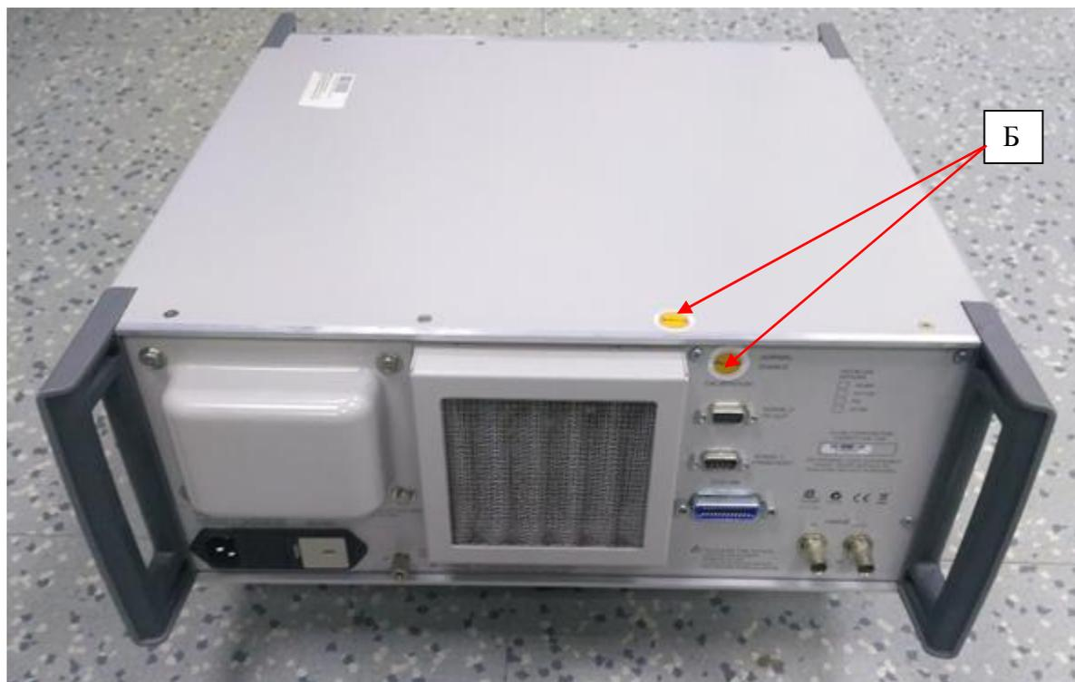
Рисунок 2 – Схема пломбировки от несанкционированного доступа (Б)
