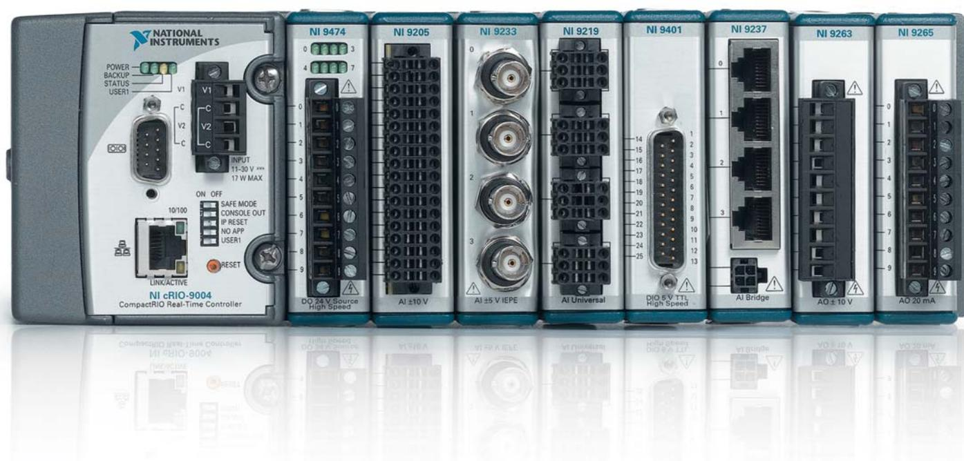
CompactRIO – это программируемый контроллер автоматизации, предназначенный для создания полнофункциональных прототипов и внедрения готовых контрольно-измерительных систем.
