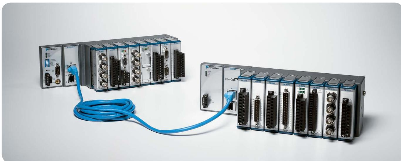
Шасси EtherCAT позволяет значительно увеличить число каналов ввода/вывода, а также производительность измерений в распределенных системах за счет точно синхронизированной во времени передачи данных измерения через протокол EtherCAT. Джиттер, возникающий при передаче данных через EtherCAT лежит в пределах 15-20 нс.
