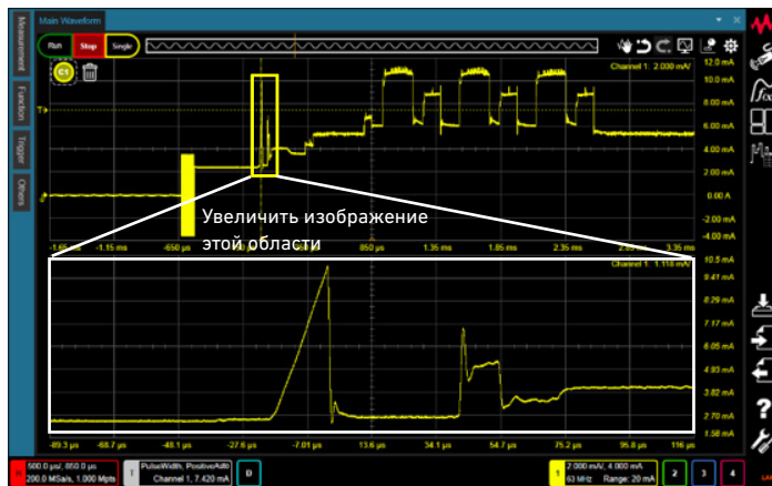
Рисунок 8. Возможность регистрации кривых быстрых переходных токов и вывода их на дисплей
