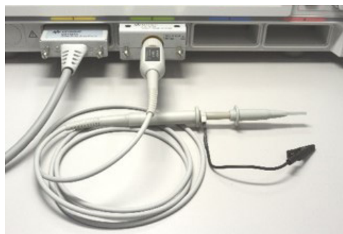
Рисунок 7. Приборы серии CX3300 также могут измерять и отображать формы кривых напряжения с помощью пассивного пробника: это позволяет просматривать кривые динамической мощности наряду с кривыми тока
