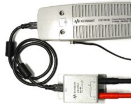
Рисунок 32. CX1206A и CX1101A. Даже при работе с маломощными устройствами время от времени может потребоваться измерить ток выше 1 А. Головка датчика CX1206A с расширителем позволяет с помощью датчика тока CX1101A измерять кривые токов от 3 мА до 10 А за счет технологии шунтирующих резисторов с приведенным сопротивлением ESL (с эффективной последовательной индуктивностью)
