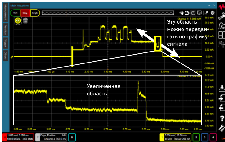
Рисунок 16. Функция масштабирования «где угодно» работает подобно направленно-му на график формы сигнала увеличительному стеклу
