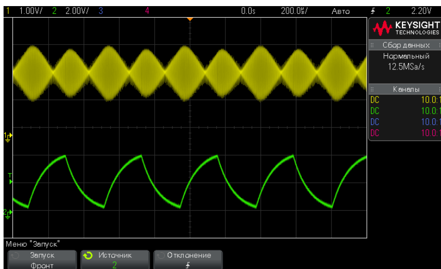
Рис. 26 Отображение амплитудной модуляции при яркости 40%
