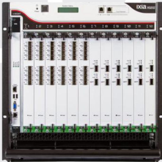
XGS12-HSL 12-слотовое, 11RU стоечное шасси
