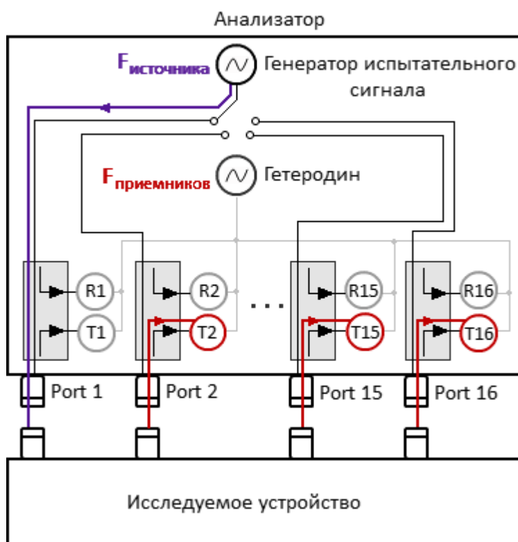
Рисунок 176 — Режимы смещения частоты источник/приёмники
