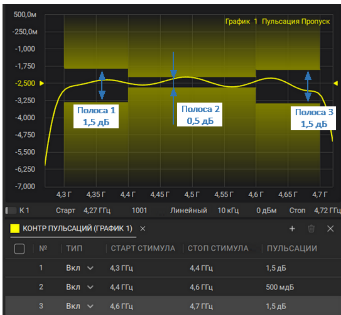
Рисунок 167 — Пример контроля пульсаций
