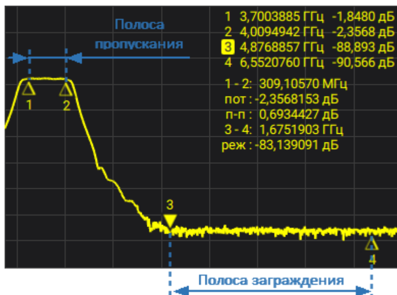
Рисунок 145 — Характеристики полосового фильтра
