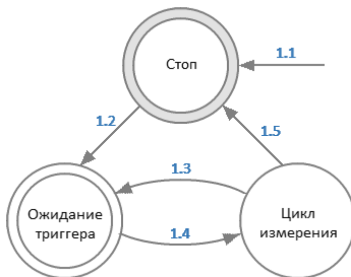
Рисунок 55 – Состояния и переходы анализатора
