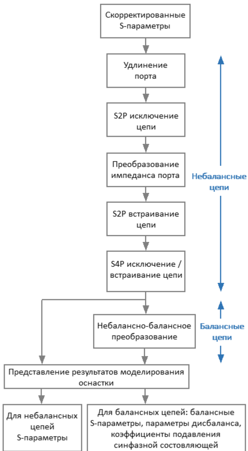
Рисунок 149 — Блок-схема обработки данных при моделировании оснастки
