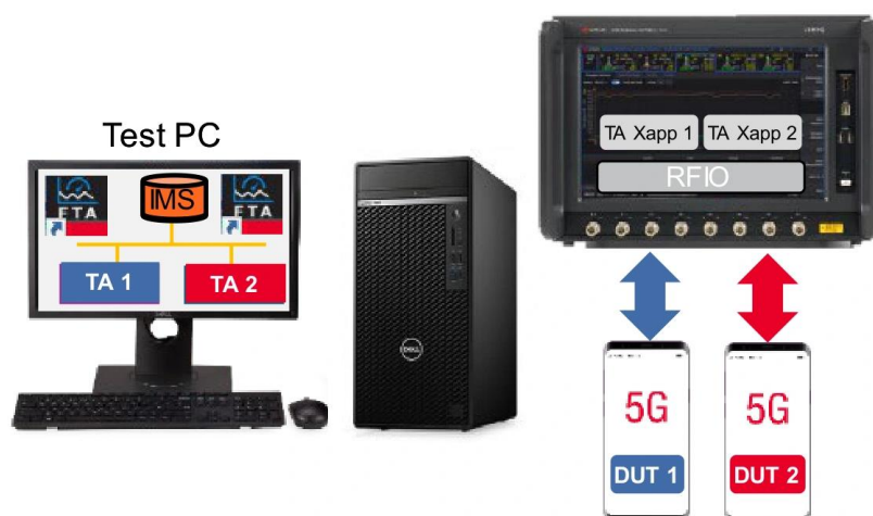
Рисунок 21. Функциональные тесты двух UE с одной UXM 5G
