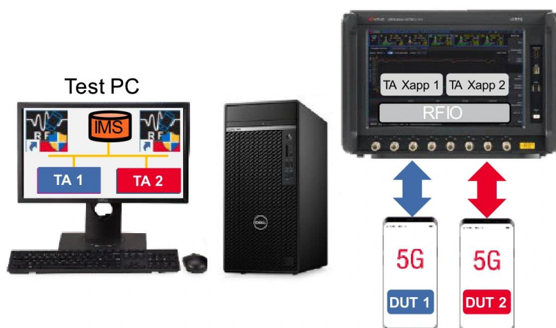
Рисунок 20. Проверка RF-характеристик двух UE с одной UXM 5G
