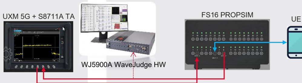
Рисунок 28. Troubleshooting NTN signaling с помощью WaveJudge
