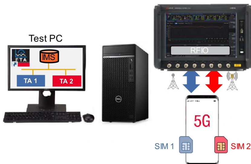
Рисунок 19. Тестирование Dual-SIM UE с одной UXM 5G
