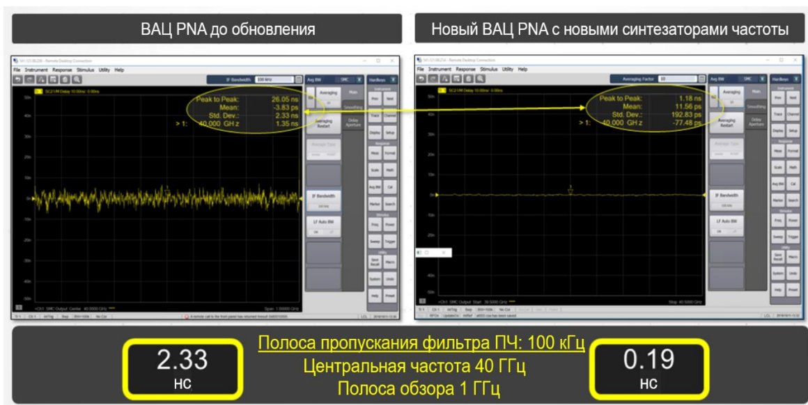
Рис. 3. Измерение ГВЗ смесителя с использованием приложения для измерения скалярных параметров и фазы преобразователей частоты (SMC+phase)
