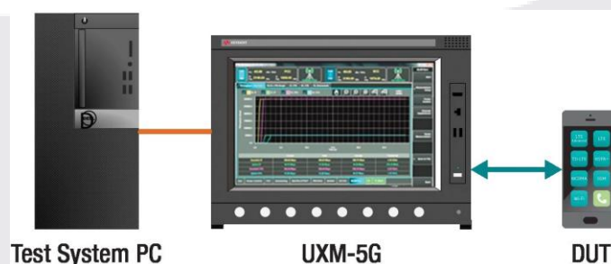
Рисунок 12. Тестовая конфигурация sub-6 GHz в режиме Standalone или Non-Standalone.
