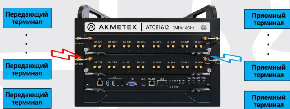
Рис. 10. Схема подключения передающих и приёмных терминалов к ATCE1612
