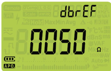
Рис. 4-7 Дисплей параметра dbrEF
