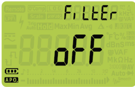
Рис. 4-2 Дисплей параметра FilTEr
