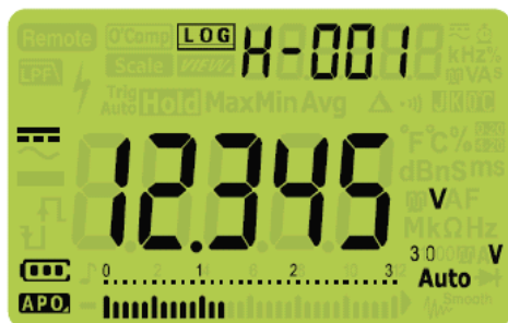
Рис. 3-7 Индикация в режиме регистрации данных с ручным запуском
