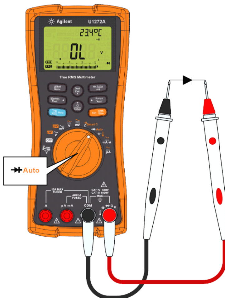
Рис. 2-21 Проверка диода при обратном смещении
