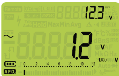
Рис. 2-10 Индикация в режиме Z_{LOW}
