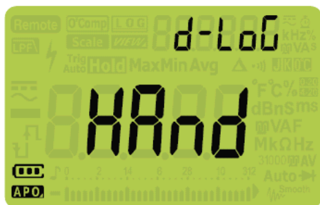
Рис. 4-4 Дисплей параметра d-LoG
