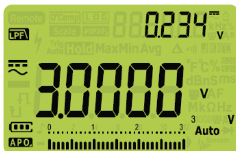
Рис. 2-4 Связь на входе по постоянному напряжению при измерении AC+DC
