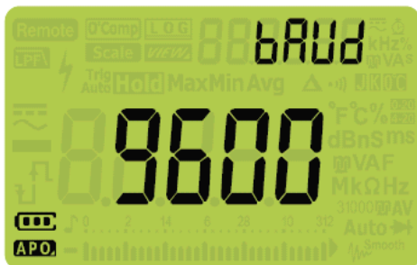
Рис. 4-14 Дисплей параметра bAUd
