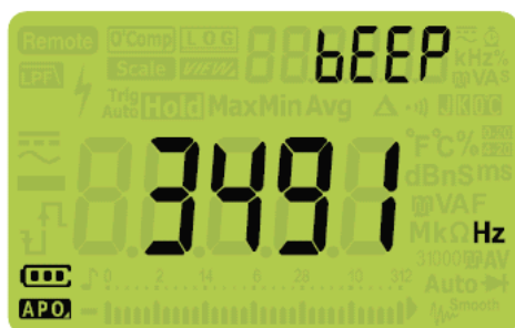
Рис. 4-1 Дисплей параметра bEEP
