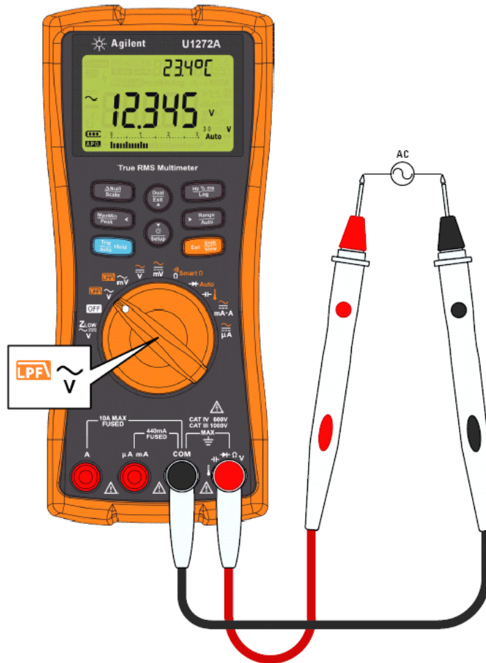
Рис. 2-2 Измерение переменного напряжения
