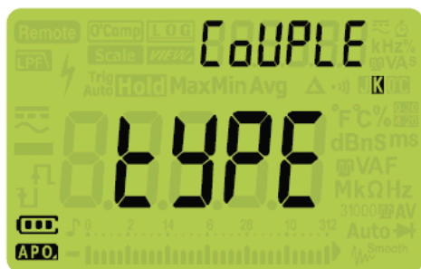
Рис. 4-12 Дисплей параметра CoUPLE
