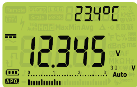
Рис. 2-5 Индикация постоянного напряжения
