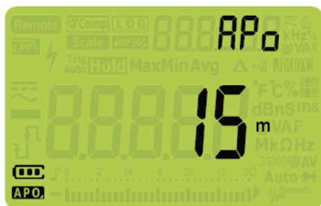
Рис. 4-8 Дисплей параметра APO
