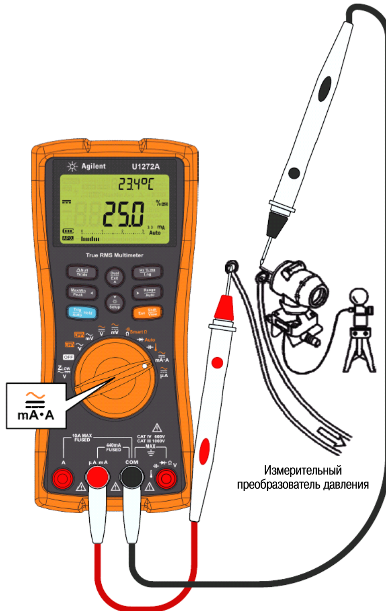
Рис. 2-34 Измерение процентного значения тока в диапазоне 4 ÷ 20 мА
