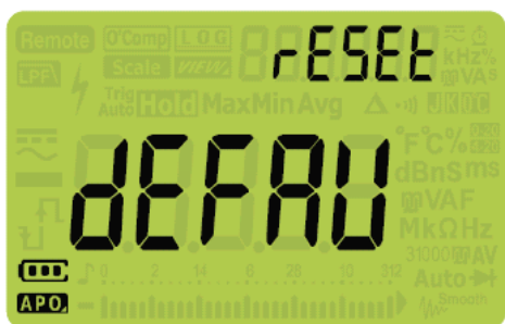
Рис. 4-20 Дисплей параметра rESEt
