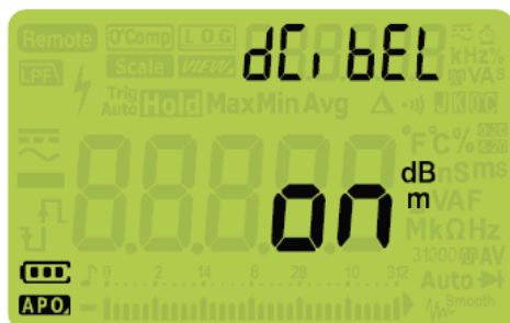
Рис. 4-6 Дисплей параметра dCibEL
