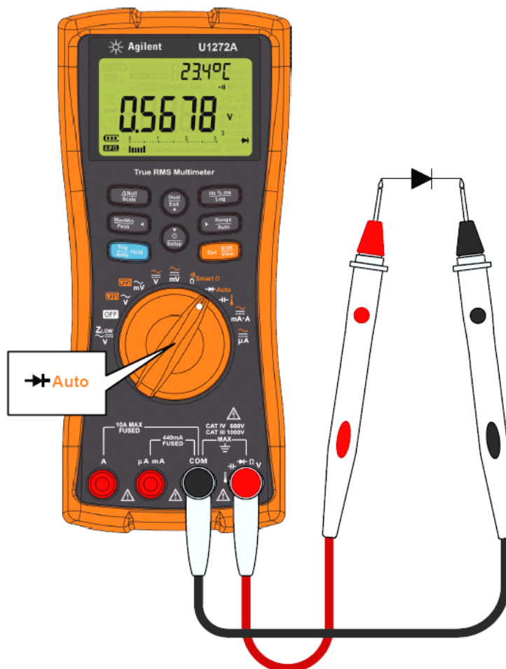
Рис. 2-20 Проверка диода при прямом смещении
