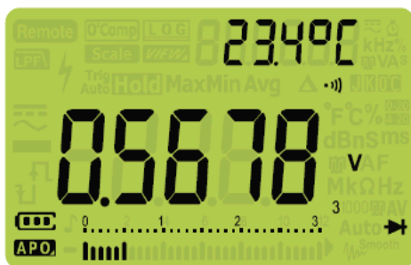
Рис. 2-18 Вид дисплея при проверке диода
