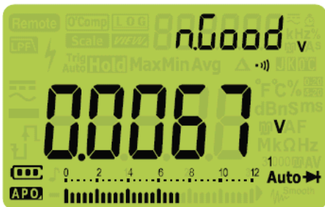
Рис. 2-23 Индикация в режиме автоматической проверки диодов – неисправный диод
