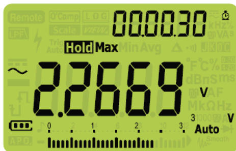
Рис. 3-5 Индикация пикового значения
