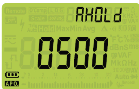
Рис. 4-3 Дисплей параметра AHOLD
