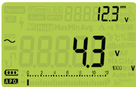
Рис. 2-11 Индикация в режиме Qik-V
