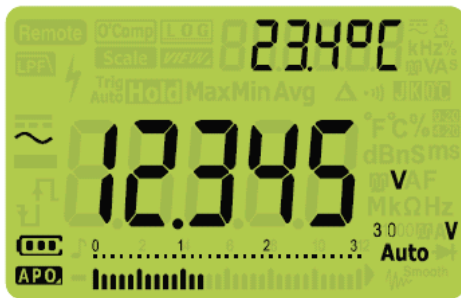
Рис. 2-1 Индикация переменного напряжения
