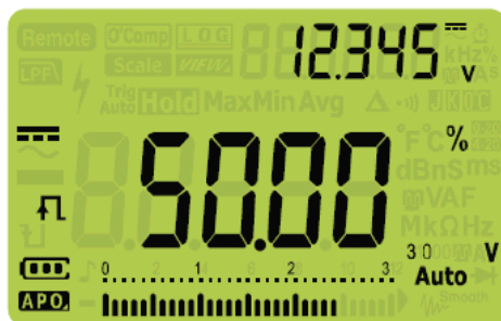
Рис. 2-39 Индикация коэффициента заполнения
