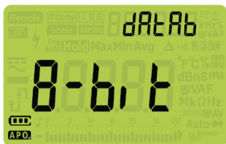
Рис. 4-15 Дисплей параметра dAtAb
