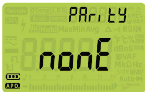
Рис. 4-16 Дисплей параметра PARITY
