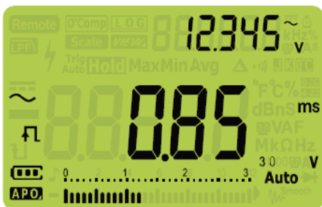
Рис. 2-38 Индикация длительности импульсов
