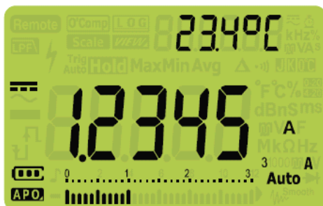
Рис. 2-29 Индикация постоянного тока
