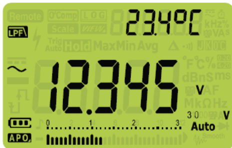
Рис. 2-3 Индикация переменного напряжения с применением фильтра нижних частот
