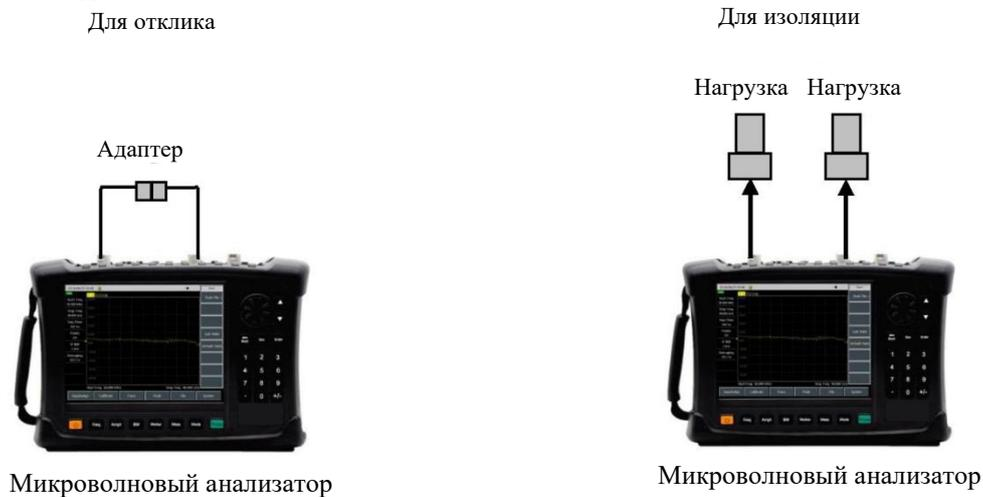
Рис. 4-5 Подключение калибровочных мер для коррекции ошибок отклика и изоляции при измерении передачи
