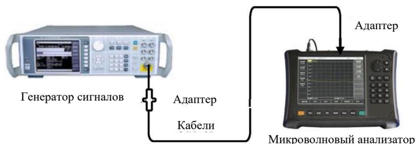
Рисунок 5-34 Блок-схема тестирования точности считываемой частоты
