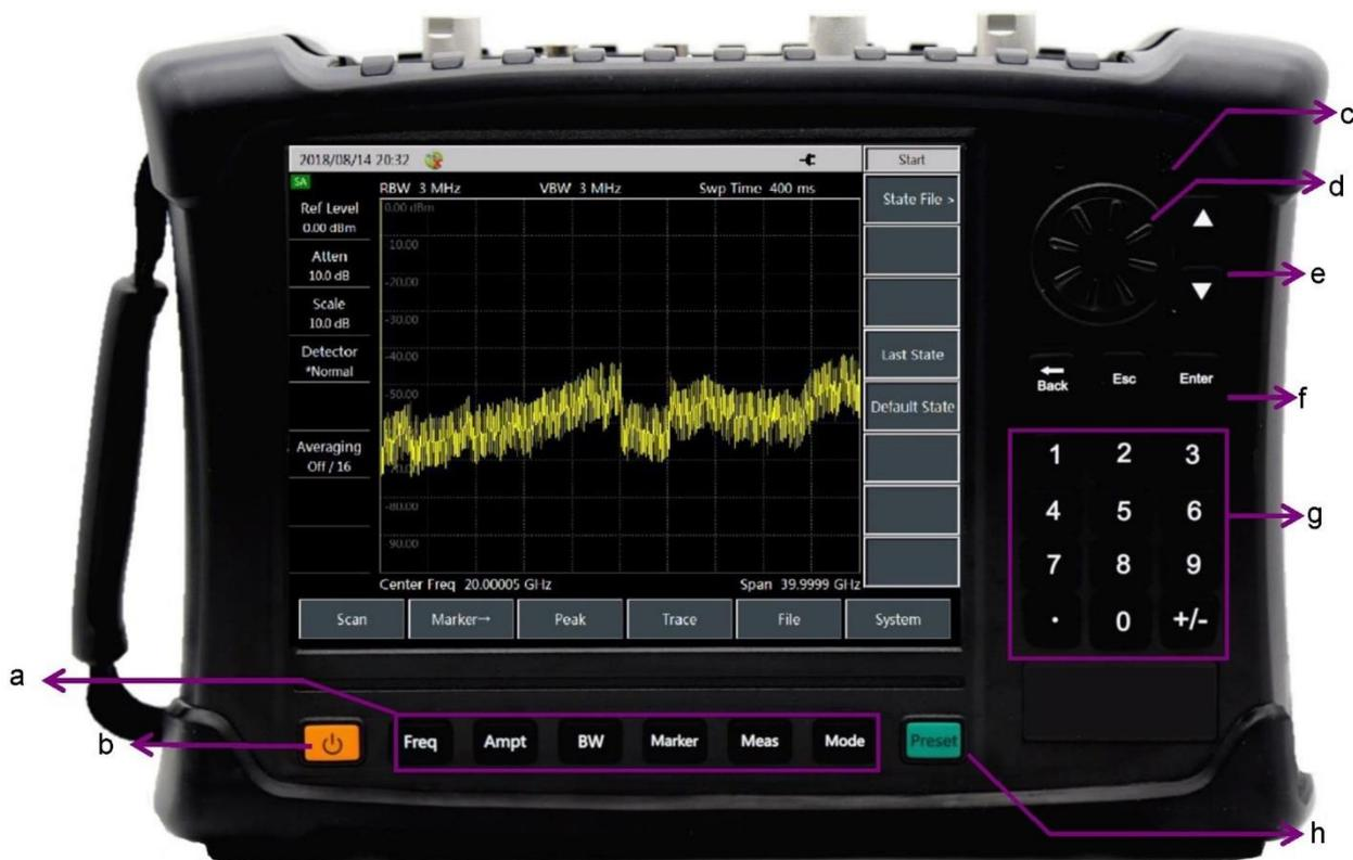
Рис. 3-5 Передняя панель микроволнового анализатора AT4957D/E/F
