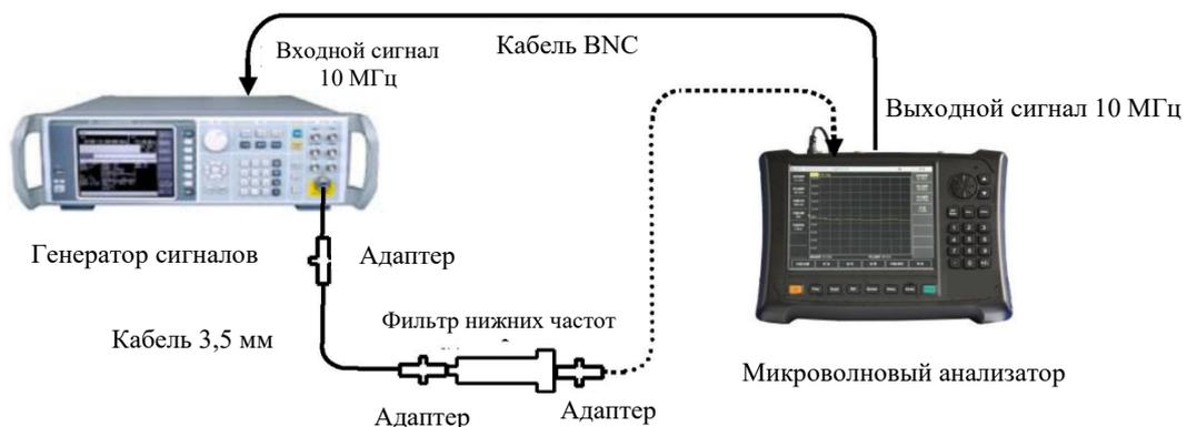
Рисунок 5-37 Блок-схема измерения искажения на второй гармонике
