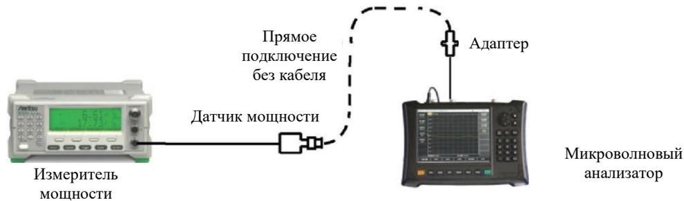
Рис. 4-14 Блок-схема теста точности установки уровня мощности
