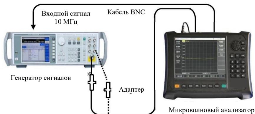
Рис. 5-33 Блок-схема теста диапазона частот
