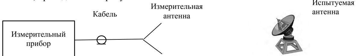
Рисунок 6 – Схема соединения приборов при измерении плотности потока энергии
