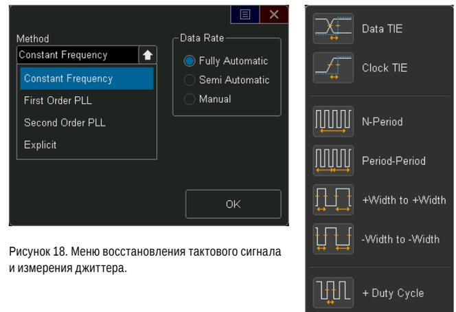
Рисунок 18. Меню восстановления тактового сигнала и измерения джиттера.
