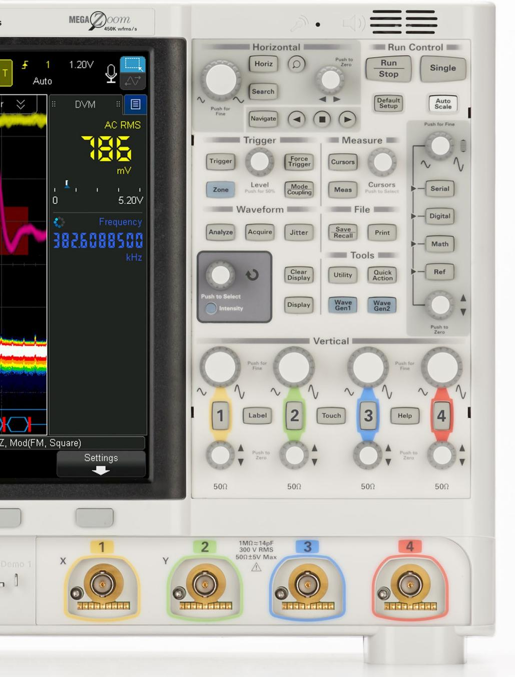
Использование панелей интерфейса на емкостном сенсорном экране повышает удобство использования. Перемещайте автоматические измерения, информацию курсоров, списки событий, гистограммы, навигацию, цифровой вольтметр и панель частотомера в любое место на экране.
