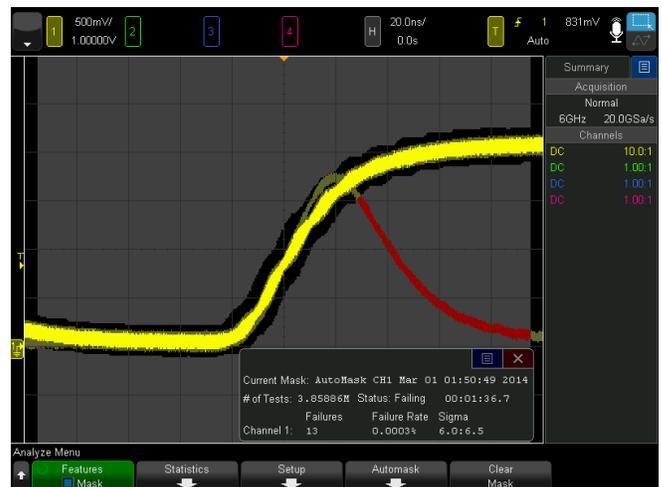
Рисунок 40. Тестирование на отклонения для выявления редких выбросов.
