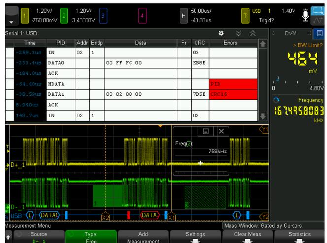
Рисунок 30. Экран опции декодирования и запуска протокола USB 2.0.
