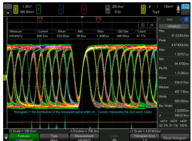
Рисунок 16б. Гистограмма результатов измерения ширины импульса.
