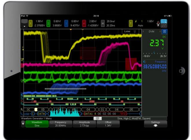
Рисунок 53. Управление осциллографом серии 6000 X с планшетного компьютера.
