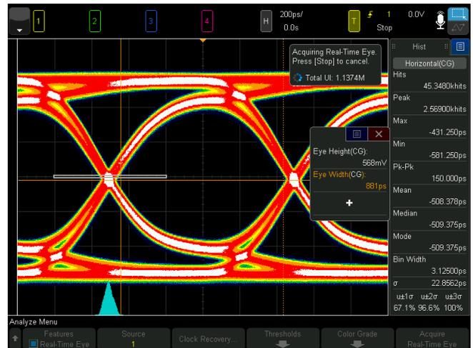
Рисунок 20. Измерение глазковой диаграммы в режиме реального времени чистого встроенного тактового сигнала псевдслучайной двоичной последовательности 1 Гбит/с. Гистограмма указывает на наличие джиттера величиной около 22 пс СКЗ.
