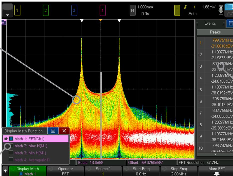
Поиск пиковой частоты и отображение в виде списка предоставляют возможности быстрого просмотра.
