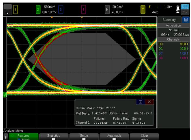
Рисунок 41. Тестирование по маске данных последовательной шины.
