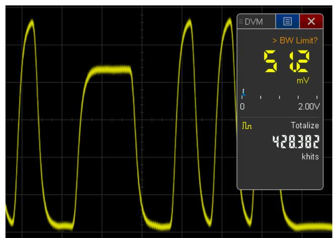
Рисунок 35. Суммирование количества вырожденных импульсов.
