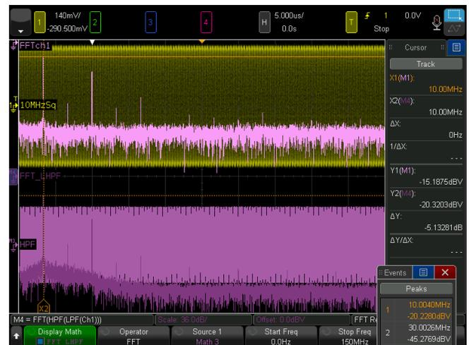
Рисунок 48. Четыре математические функции используются одновременно (три включены).
