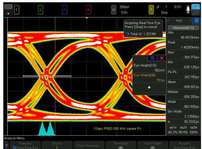
Рисунок 21. Измерение глазковой диаграммы в режиме реального времени встроенного тактового сигнала псевдслучайной двоичной последовательности 1 Гбит/с с джиттером. Гистограмма указывает на бимодальный характер распределения и величину джиттера около 55 пс СКЗ.
