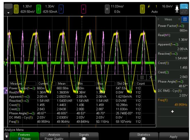
Рисунок 43. Снимок экрана анализа качества шин питания.
