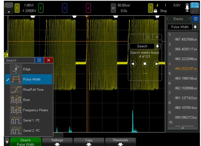
Рисунок 42. Поиск и переход к импульсам конкретной длительности.
