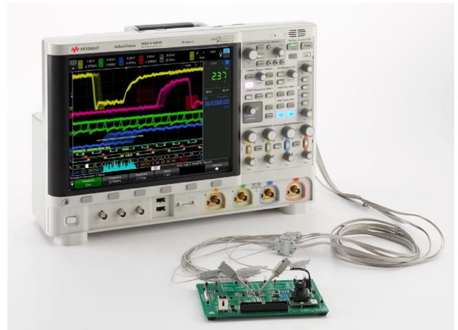
Рисунок 27. Осциллограф MSO с новым кабелем для цифровых каналов.
