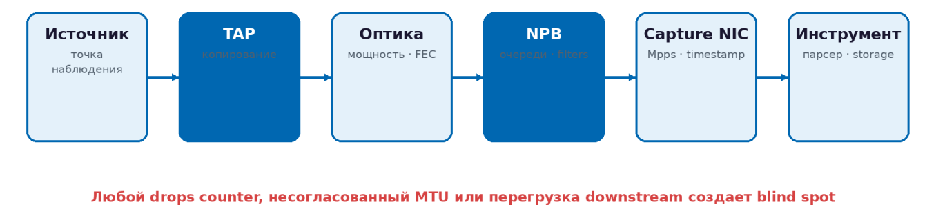
Рисунок 1. Гарантировать необходимо не TAP отдельно, а сквозной тракт доставки пакетов.
