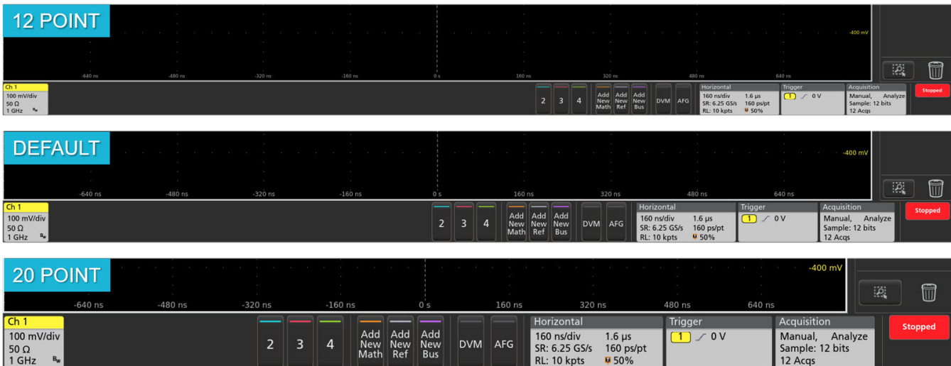
Сравнение, показывающее, как изменяется масштаб пользовательского интерфейса по мере изменения размера шрифта.
